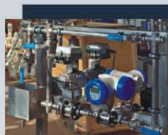
Станции дозирования реагентов на обогатительной фабрике ОАО «Кольская ГМК»
