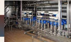
Блоки распределителей SV управляют продуктовыми клапанами на молочном заводе
