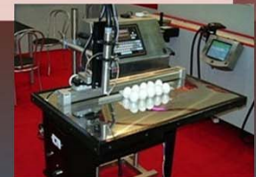
Бесштоковый пневмоцилиндр MY1B перемещает головку принтера для маркировки продукции
