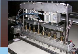
MGP приводят в действие дозатор на кондитерской фабрике
